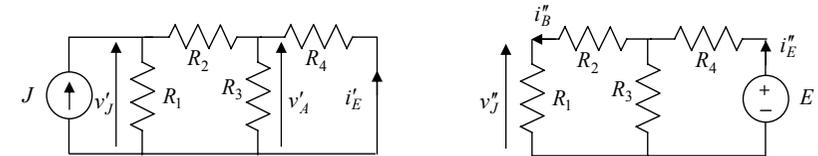
Con riferimento al primo circuito ausiliario, il contributo  $v'_J$  è ottenuto valutando la resistenza equivalente vista dal generatore:
