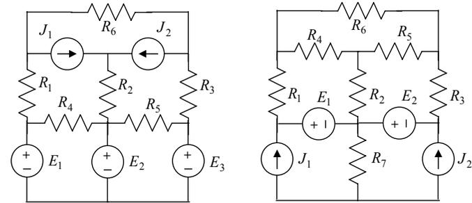
**ES. 4.5** - Utilizzando il metodo delle correnti di maglia calcolare la corrente in  $R_2$ .
