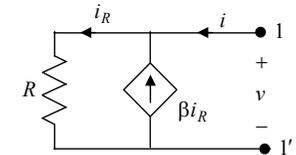
Per  $\beta > 1$  si ha  $R_{eq} < 0$ , risultato plausibile visto che nella rete è presente un bipolo attivo. Per  $\beta = 1$  non esiste il circuito equivalente di Thévenin.
