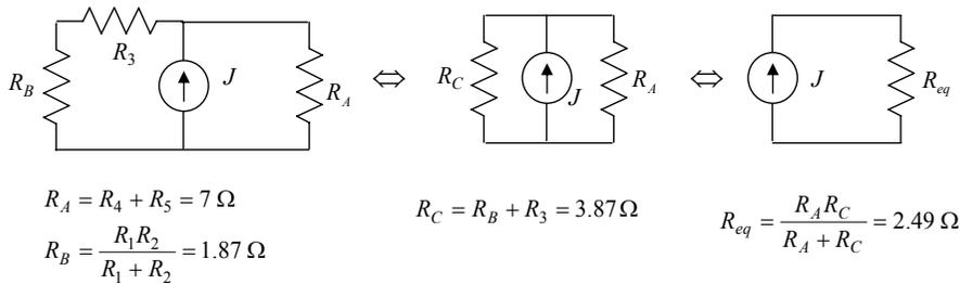
**ES. 1.3** - Calcolare la  $R_{eq}$  vista ai morsetti A-B e quella vista ai morsetti C-D.
