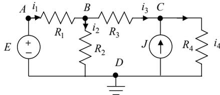
Avendo scelto come potenziale di riferimento quello del nodo D, le incognite saranno i potenziali degli altri tre nodi:  $e_A, e_B, e_C$ . Per la presenza del generatore di tensione tra nodo A e nodo D, si ha banalmente  $e_A = E$ . Con le convenzioni adottate si ha:
