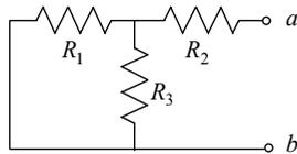
$$R_{eq} = R_2 + R_1 // R_3 = R_2 + \frac{R_1 R_3}{R_1 + R_3}$$
