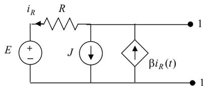
Risultato:  $V_0 = E + \frac{RJ}{\beta - 1}$ ,  $R_{eq} = \frac{R}{1 - \beta}$ .
