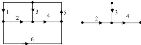
$$\text{LKT} \begin{cases} v_1 + v_2 - v_3 = 0 \\ v_3 + v_4 + v_5 = 0 \\ -v_2 - v_4 + v_6 = 0 \end{cases}$$
