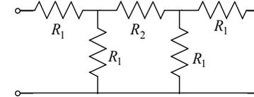
quindi corrisponde alla conduttanza di ingresso della rete descritta in alto. Applicando le regole di equivalenza serie e parallelo di conduttanze si ottiene:
