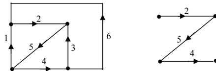
$$\text{LKT} \begin{cases} -v_1 - v_2 - v_5 = 0 \\ v_2 + v_4 + v_5 + v_6 = 0 \\ v_3 + v_4 + v_5 = 0 \end{cases}$$
