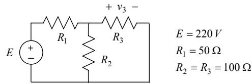
Il partitore di tensione si applica a due resistori in serie, quindi occorre preliminarmente ricondursi alla rete equivalente seguente:
