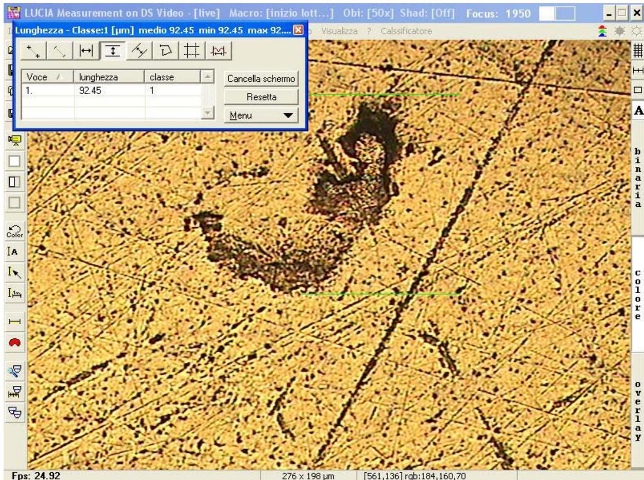
**figura 5.61** immagine del difetto ottenuto a  $x = +3.5$  mm il cui spessore è di 0.092 mm
