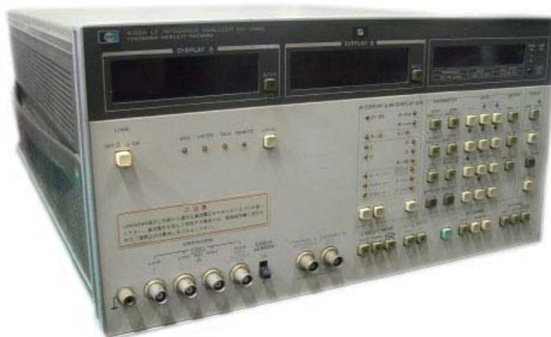
**figura 3.1** Analizzatore di impedenza HP 4192LF DIGITAL LCR METER
