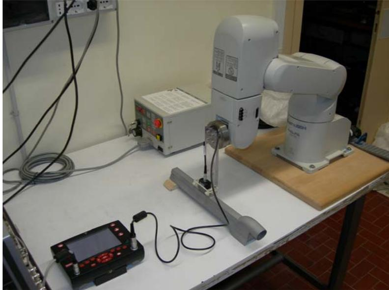
**figura 5.25** scansione del componente di interesse aeronautico
