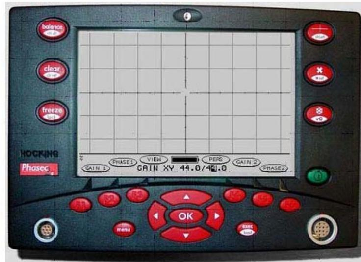
figura 3.2 Difettoscopio Phasec2D
