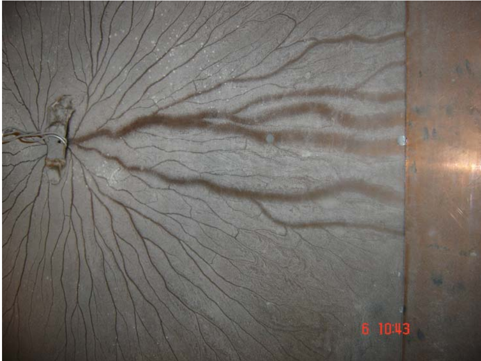
Dettaglio della zona di scarica
