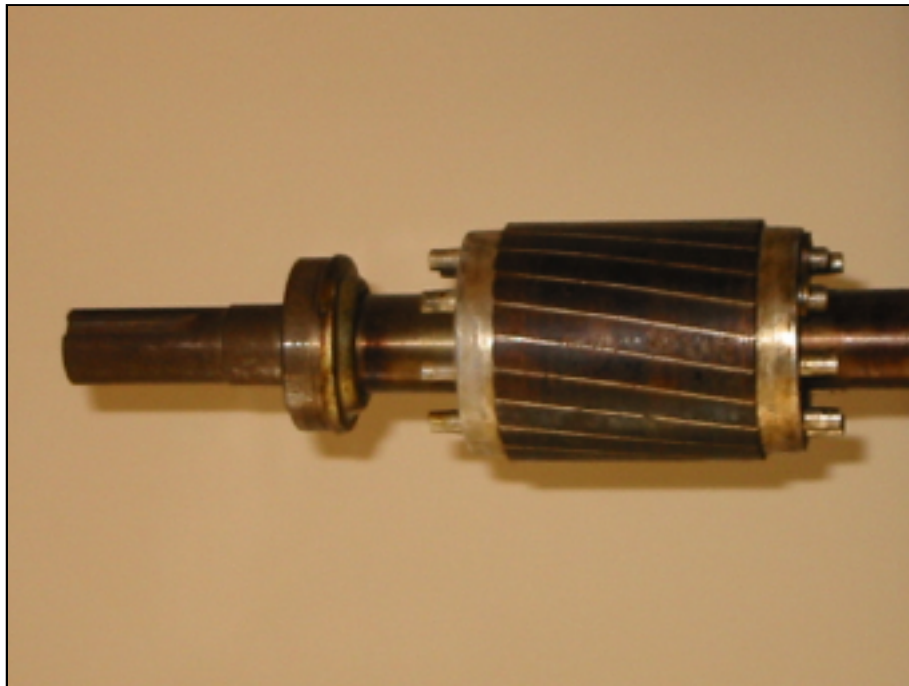
Figura 3.10: rotore a gabbia di scoiattolo.
