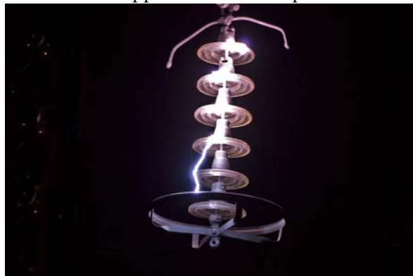
fig. 8 – Scarica superficiale (flashover)
