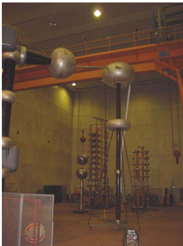
fig.2 – Generatore ad impulso, spinterometro a sfere e divisore di tensione ohmico-capacitivo (sullo sfondo); in alto: schema semplificato (R: raddrizzatore; M: circuito moltiplicatore ad innesco comandato; S: spinterometro a sfere; OP: oggetto in prova; PR: partitore resistivo compensato; DT: digitalizzatore Tektronix)
