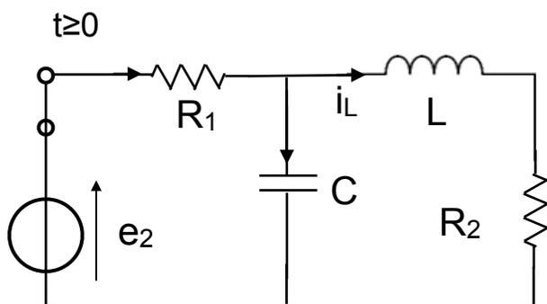
$$e_2 = R_1 i_1 + L \frac{di_L}{dt} + R_2 i_L$$
