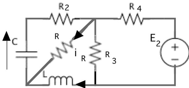
Poiché il condensatore in c.c. equivale ad un circuito aperto, la corrente in  $L$  per  $t \leq 0$  è quella che circola in  $R$  e quindi il risultato della ripartizione della corrente erogata dal generatore nei due rami in parallelo  $R$  ed  $R_3$ .
