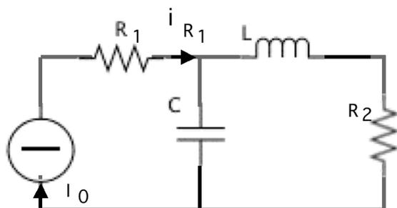
Considerando che in continua il condensatore è un circuito aperto e l'induttore un corto circuito si ottengono le seguenti condizioni iniziali:
