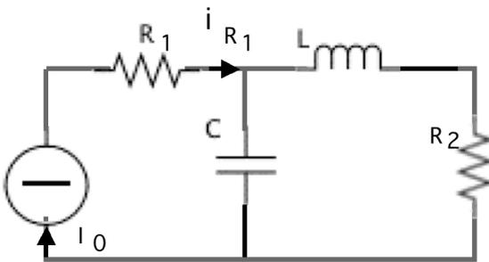
Considerando che in continua il condensatore è un circuito aperto e l'induttore un corto circuito si ottengono le seguenti condizioni iniziali:
