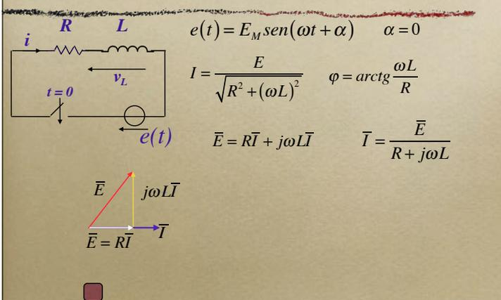
Nella figura è rappresentato anche il diagramma fasori del circuito in esame. Si parte dal fasore della corrente e da quello della caduta sul resistore, che è proporzionale, e quindi in fase, alla corrente. Poi si disegna il fasore della tensione sull'induttore, a  $90^\circ$  gradi in anticipo. Infine la congiungente l'origine con l'estremo della caduta induttiva rappresenta il fasore della tensione  $E$ .
