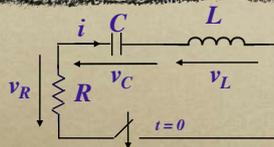
A questo punto possiamo provare a mettere insieme i due nuovi bipoli in un circuito RLC serie. Verifichiamo in laboratorio il funzionamento del circuito.
