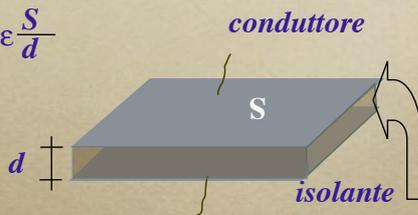
*Nel S.I. La capacità C si misura in Farad*
