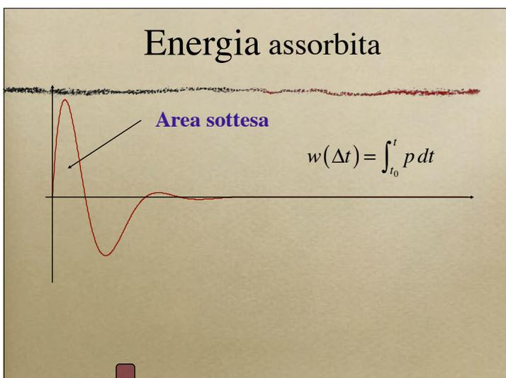
Per approfondire ancora l'argomento proviamo a calcolare l'energia fornita al bipolo in un intervallo di tempo  $(t_0, t)$ .
