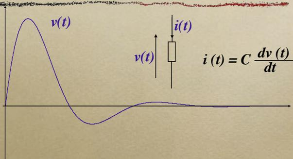
Nell'immagine a lato sono rappresentati gli andamenti di tensione e corrente in un condensatore per un caso particolare: si noti che, essendo la corrente proporzionale alla derivata della tensione, essa è nulla dove la tensione ha un massimo o un minimo.
