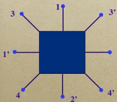
Accoppiando a due a due i morsetti di un N-polo, si ottiene un n-bipolo o n-porte.
