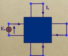
Accoppiando a due a due i morsetti di un N-polo, si ottiene un n-bipolo o n-porte.
