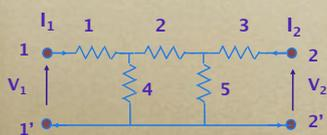
Calcolare la matrice delle R e delle G per il seguente doppio bipolo.
