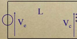
La potenza fornita dal generatore è in parte dissipata dalla linea!
