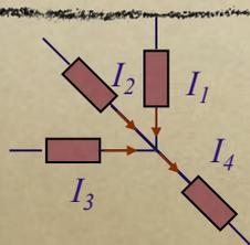
*In ogni nodo la somma algebrica delle correnti entranti o uscenti da un nodo è identicamente nulla.*
