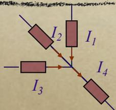
*In ogni nodo la somma algebrica delle correnti entranti o uscenti da un nodo è identicamente nulla.*
