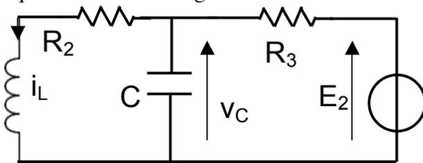
Poiché il condensatore in c.c. equivale ad un circuito aperto, la corrente in  $L$  per  $t \leq 0$  è quella che circola in  $R_2$  e quindi quella erogata dal generatore. In queste condizioni il generatore  $E_2$  vede la serie di  $R_3$  e di  $R_2$  e quindi:
