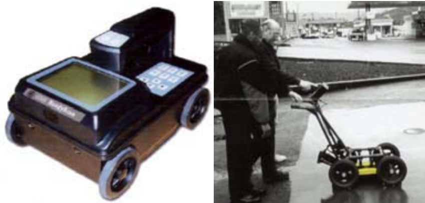
Figura 2.3 Ground Penetrating Radar per la rivelazione di delaminazioni, crepe, cavità e ferri dell'armatura nelle strutture in cemento armato.
