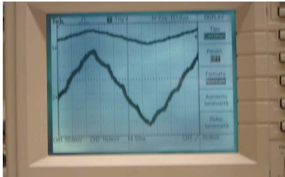
Figura 2.24 : Onda triangolare a frequenza 2,5MHz ed ampiezza 5V
