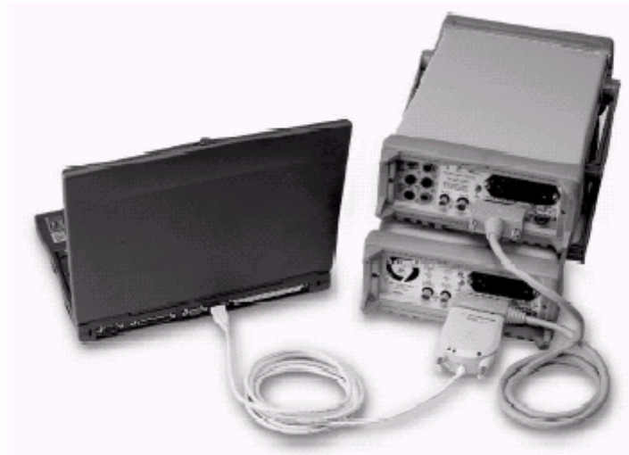
Figura 13– Esempio di connessione con interfaccia USB e PC portatile
