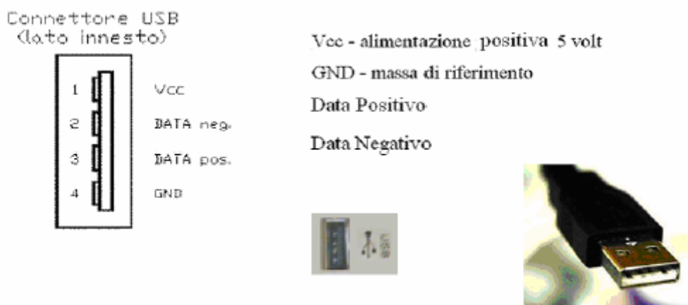
Figura 14- Schema del connettore della porta di comunicazione USB presente sul Pc.
