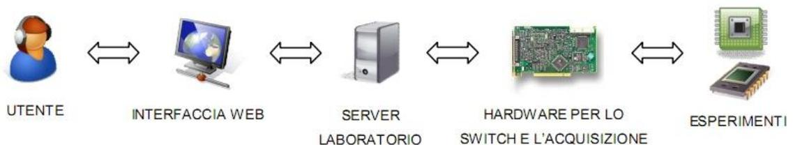
**Figura 1.1:** Struttura del laboratorio remoto di circuiti
