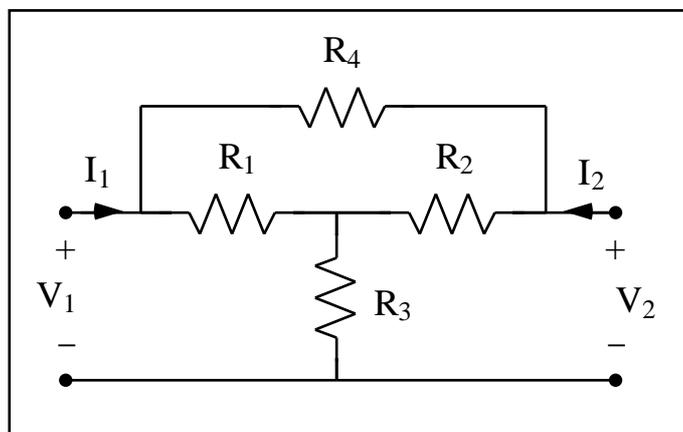
Dati:  $R_1 = R_2 = R_3 = R_4 = 6 \text{ } \Omega$  .
