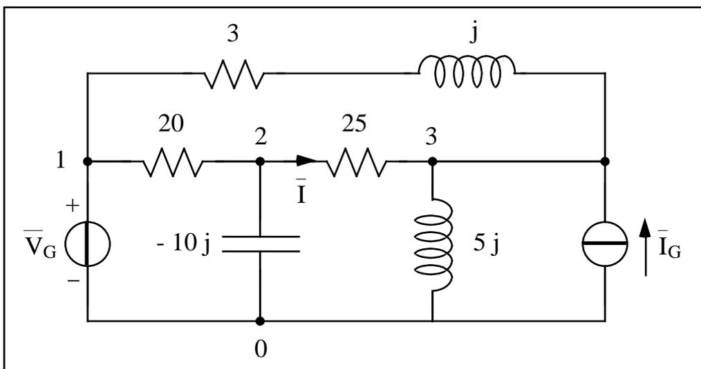
Dati:  $\bar{V}_G = 10 \text{ V}$ ,  $\bar{I}_G = -25 \text{ j A}$ .
