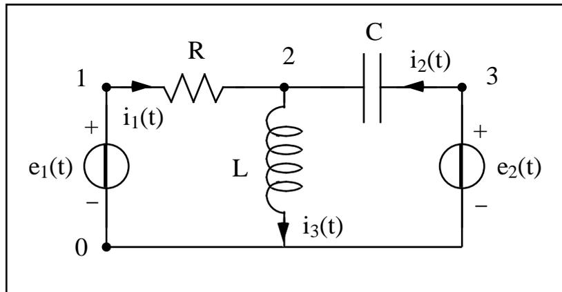
Dati:  $e_1(t) = E_1 \cos(\omega t)$ ,  $e_2(t) = E_2 \sin(\omega t)$ ,  $E_1 = E_2 = 10 \text{ V}$ ,  $\omega = 1 \text{ krad/s}$ ,
