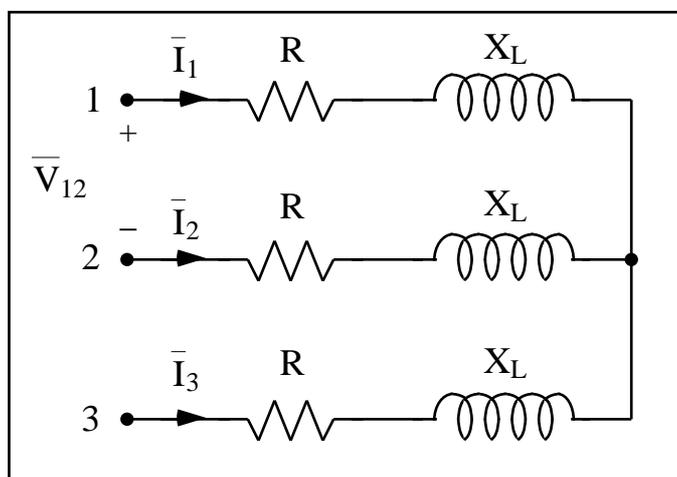
Dati:  $R = X_L = 5 \text{ } \Omega$ ,  $V_{12} = V_0 = 380 \text{ V}$ ,  $f = 50 \text{ Hz}$ .
