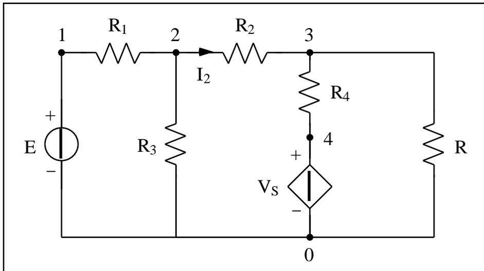
Dati:  $R_1 = 25$  ,  $R_2 = 10$  ,  $R_3 = 100$  ,  $R_4 = 20$  ,  $E = 200$  V,  $V_S = r I_2$ ,
