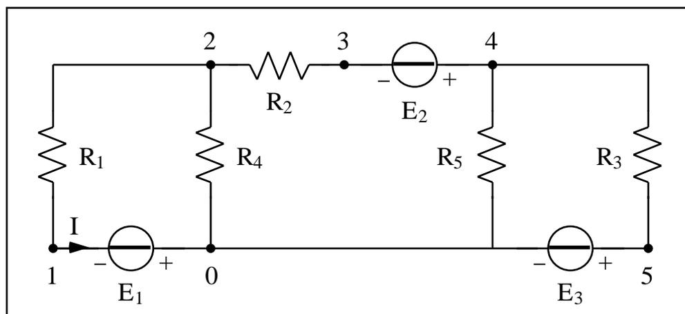
Dati:  $E_1 = E_2 = 10 \text{ V}$ ,  $E_3 = 8 \text{ V}$ ,  $R_1 = 9 \ \Omega$ ,  $R_2 = 10 \ \Omega$ ,  $R_3 = 3 \ \Omega$ ,  $R_4 = 5 \ \Omega$ ,  $R_5 = 2 \ \Omega$ .
