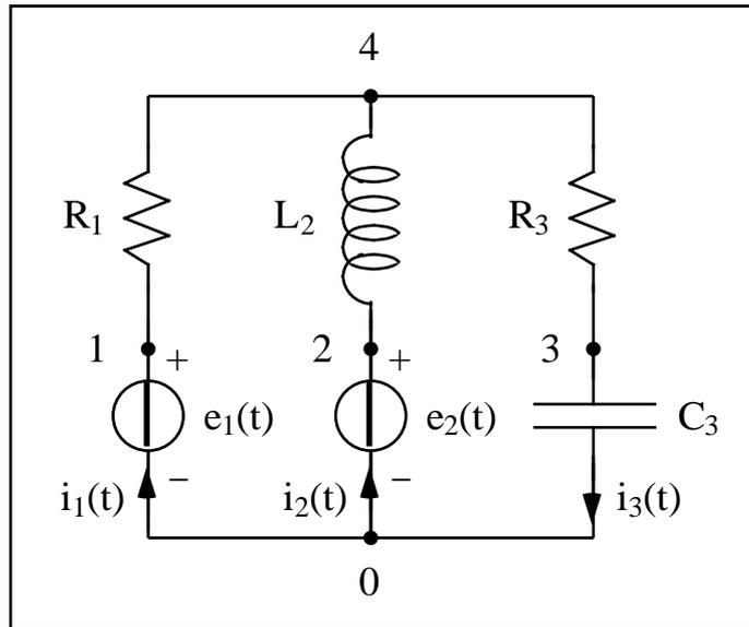
Dati:  $e_1(t) = E_1 \sin(\omega t)$ ,  $E_1 = 10 \text{ V}$ ,  $e_2(t) = E_2 \sin(\omega t)$ ,  $E_2 = 20 \text{ V}$ ,  $\omega = 1 \text{ krad/s}$ ,
