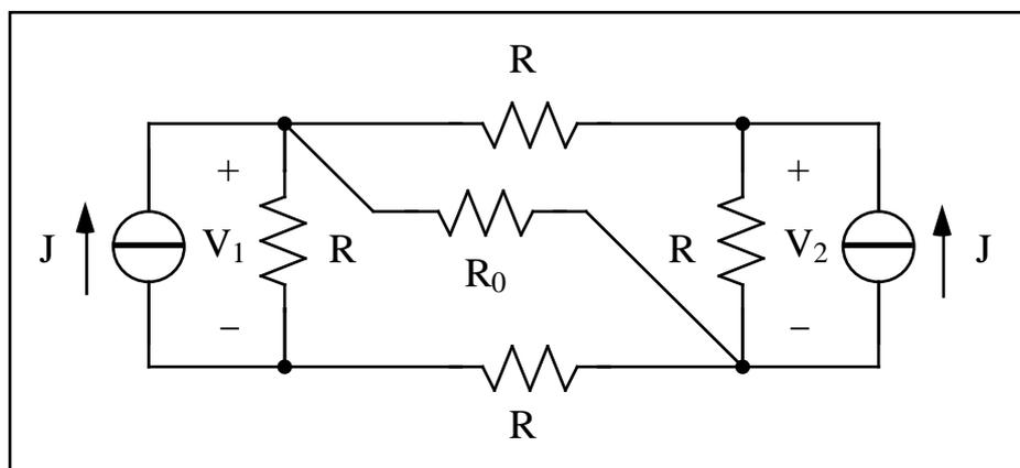
Dati:  $J = 10 \text{ A}$ ,  $R = 1 \text{ } \Omega$ ,  $R_0 = 2 \text{ } \Omega$ .
