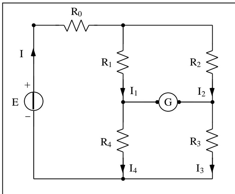
Lo strumento indicato con 'G' è un galvanometro. Potete immaginare che si tratti di un misuratore di corrente molto sensibile, capace di rilevare correnti molto piccole, fino a qualche nanoampere.
