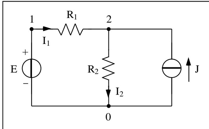
Dati:  $E = 10 \text{ V}$ ,  $J = 2 \text{ A}$ ,  $R_1 = 5 \text{ } \Omega$ ,  $R_2 = 20 \text{ } \Omega$ .
