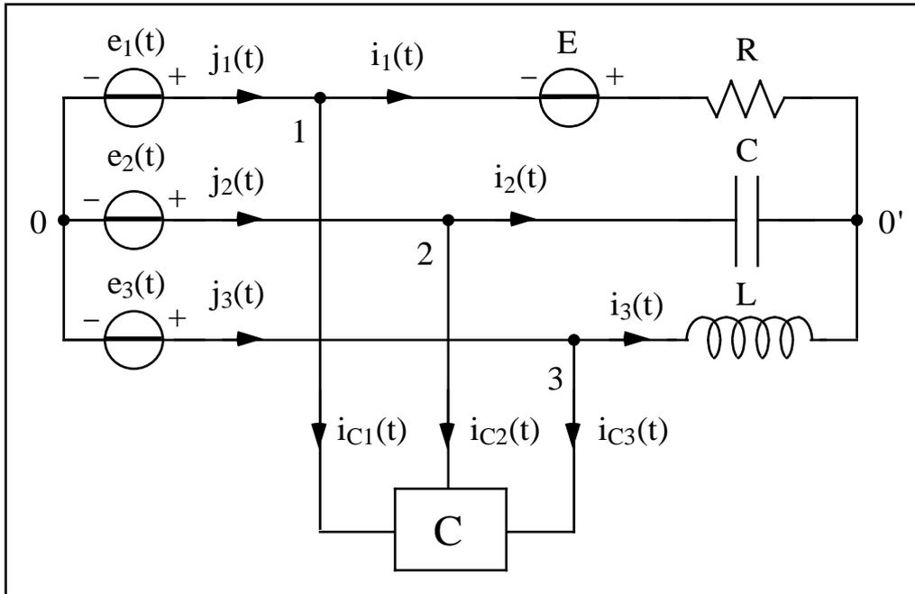
[Attenzione: si tratta di un esercizio veramente complicato in cui è necessario applicare la sovrapposizione degli effetti. Il generatore 'E' eroga una tensione continua, non alternata].
