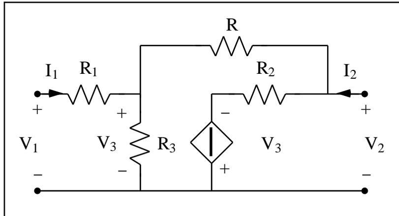
Dati:  $R_1 = 5$  ,  $R_2 = 50$  ,  $R_3 = 25$  ,  $R = 100$  ,  $\beta = 13$ .
