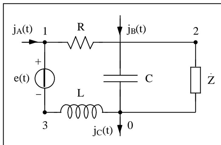
Dati:  $\omega = 100 \text{ rad/s}$ ,  $e(t) = E \sin(\omega t)$ ,  $E = 100 \text{ V}$ ,  $j_A(t) = J_A \sin(\omega t - \pi/4)$ ,
