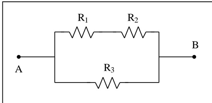
Dati:  $R_1 = 5 \text{ } \Omega$  ,  $R_2 = 5 \text{ } \Omega$  ,  $R_3 = 30 \text{ } \Omega$  .
