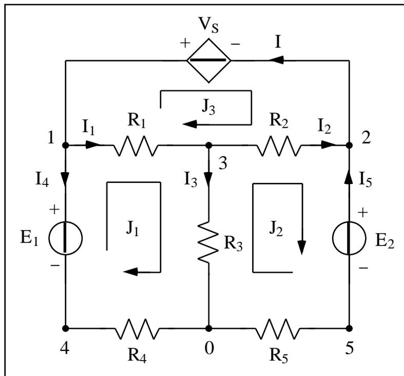
Dati:  $E_1 = -10 \text{ V}$ ,  $E_2 = 24 \text{ V}$ ,  $V_S = I_3$ ,  $I_3 = 7$ ,  $R_1 = 1$ ,  $R_2 = 2$ ,  $R_3 = 3$ ,  $R_4 = 4$ ,  $R_5 = 5$ .
