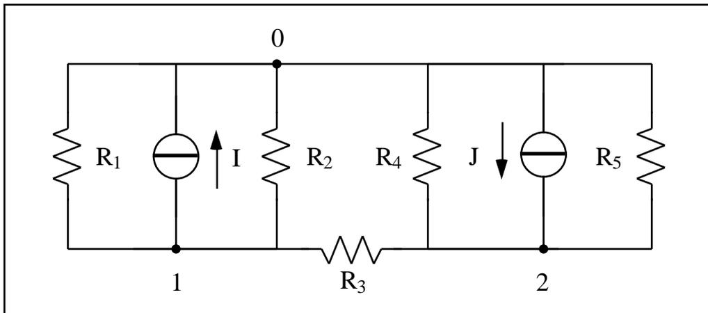
Dati:  $I = 3$  A,  $J = 16$  A,  $R_1 = 10$  ,  $R_2 = R_3 = 2$  ,  $R_4 = 6$  ,  $R_5 = 12$  .
