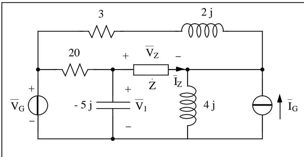
Dati:  $\bar{V}_G = (100 - 50j) \text{ V}$ ,  $\bar{V}_1 = (40 + 30j) \text{ V}$ ,  $\bar{I}_G = (20 + 30j) \text{ A}$ .
