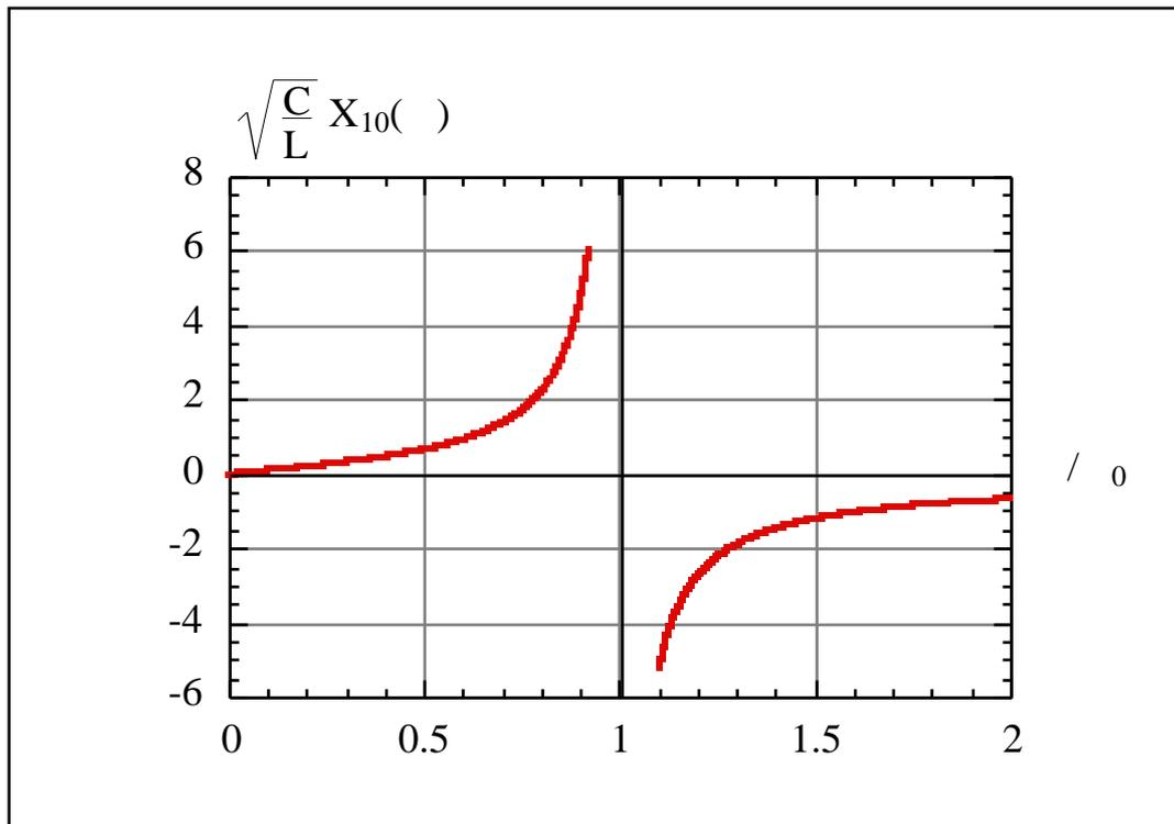
Notate che la reattanza è una funzione non definita per  $\omega = \omega_0$ : si dice che la funzione ha in corrispondenza di questo punto un asintoto verticale, attorno al quale la reattanza assume valori molto elevati, al limite infiniti.
