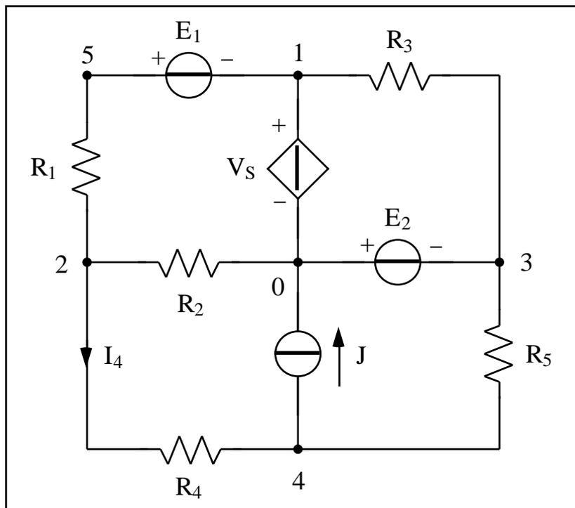
Dati:  $E_1 = 16 \text{ V}$ ,  $E_2 = 8 \text{ V}$ ,  $J = 1 \text{ A}$ ,  $V_S = I_4$ ,  $\dots = 4$ ,  $R_1 = 2$ ,  $R_2 = 3$ ,  $R_3 = 2$ ,  $R_4 = 6$ ,  $R_5 = 8$ .
