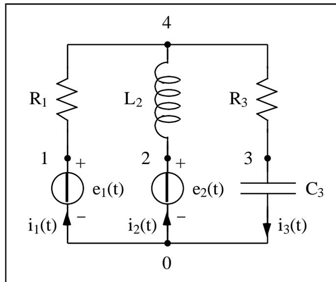
Dati:  $e_1(t) = E_1 \sin(\omega t)$ ,  $E_1 = 10$ ,  $e_2(t) = E_2 \sin(\omega t)$ ,  $E_2 = 20$ ,  $\omega = 1 \text{ krad/s}$ ,
