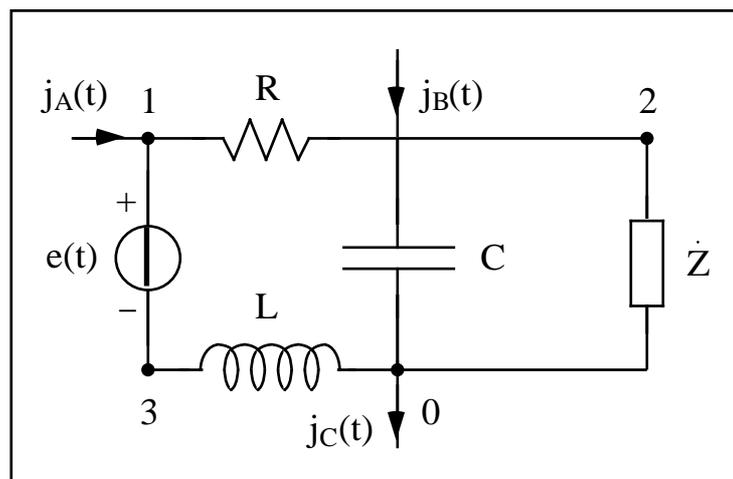
Dati:  $\omega = 100 \text{ rad/s}$ ,  $e(t) = E \sin(\omega t)$ ,  $E = 100$ ,  $j_A(t) = J_A \sin(\omega t - \pi/4)$ ,  $J_A = 20$ ,  $j_B(t) = J_B \cos(\omega t)$ ,  $J_B = 5$ ,  $R = 10$ ,  $L = 0.1$ ,  $C = 1 \text{ mF}$ .
